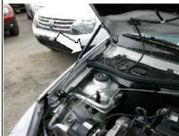
5. Прокачать амортизаторы (упереть в твердую поверхность, несколько раз полностью сжать и отпустить)
