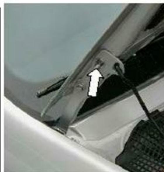
3. Открутить верхний болт крепления капота. (Рис. 3)
